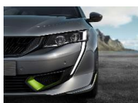
De store luftinntakene med Kryptonite-farge gir mer luft og dermed en bedre motorkjøling
